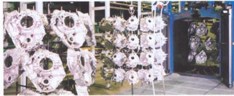
Shot Peening-Anlage mit reproduzierbarem Strahlzyklus zur Verfestigung von Getriebeteilen
