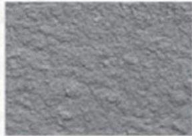
CSP 5 (medium-heavy shotblast)
